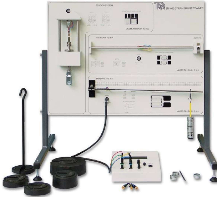
Şekil 4. Strain Gauge deney seti, ağırlıklar, moment çubuğu ve dijital gösterge
