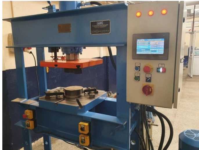
Şekil 10. PLC kontrollü 30 tonluk hidrolik pres
