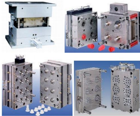
Şekil 4. Farklı enjeksiyon kalıpları
